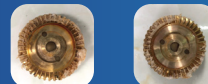
Sử dụng máy bơm khi kéo dẫn ống nước chưa khô hoàn toàn sẽ khiến phần keo dư dính lên bề mặt cánh bơm.
