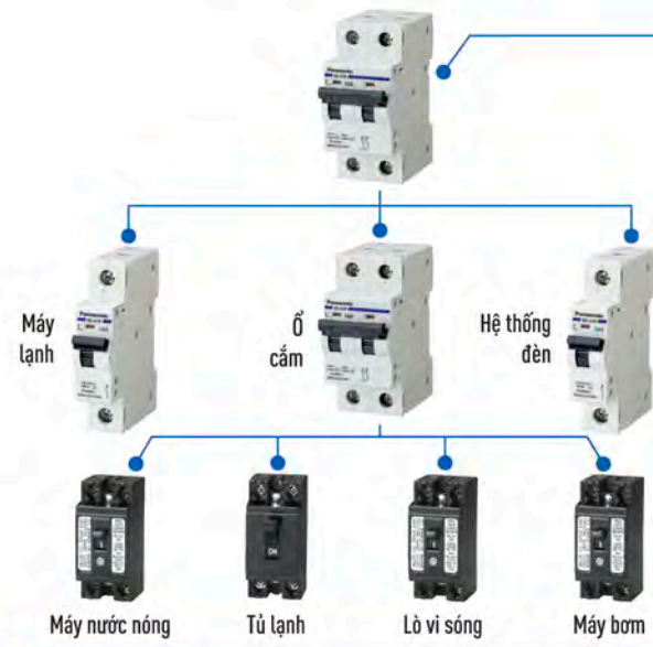
Hệ thống điện tầng 1
